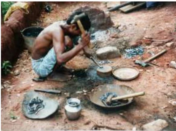
**Bild 2** Alle Werkzeuge, Hämmer, Meißel, Holzkohle, Esse, Blasebalg, Schalen mit Halbzeug und mit fertigen Nägeln
