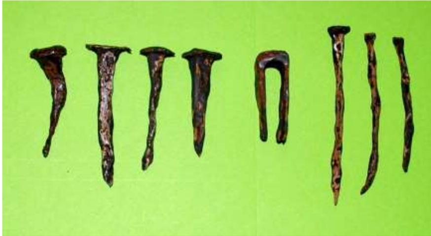
Links vier geschmiedete Vierkantnägel die wahrscheinlich +/- 2000 Jahre im Boden *der Gleicht* überdauerten. In der Mitte das gebrochene Heft eines kleinen Hammers oder Beiles unbekannter Zeitstellung. Rechts zum Qualitätsvergleich drei neuzeitliche Rundnägel welche maximal etwas mehr als hundert Jahre der Oxidation im Boden *der Gleicht* ausgesetzt waren. Nur Impact: Wasser-Salz-Sauerstoff? Qualität?
