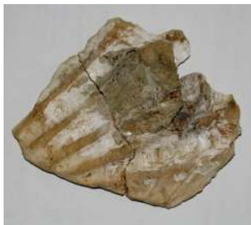
Jacobsmuschel auf extrem gehärtetem Kalkmörtelbrocken aufgeklebt
