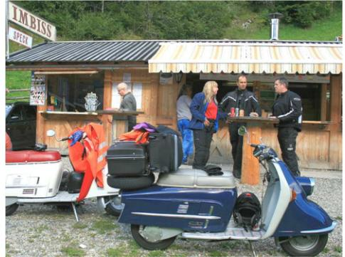
Der **“Heinkel Tourist”** ist ein Motorroller mit luftgekühltem Einzylinder-Viertaktmotor mit einen Hubraum von 149 cm<sup>3</sup> (7,2 PS) bis 174 cm<sup>3</sup> (9,5 PS), den die Ernst Heinkel Flugzeugwerke von 1953 bis 65 herstellten. (V-max: 95 km/h - Verbrauch: weniger als 3 Liter auf 100km.)
